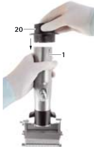
Рис. 3 Установка стерильного переходника
