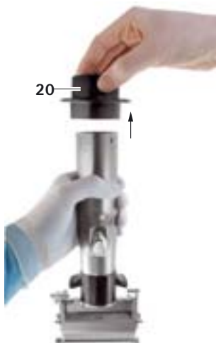
Fig. 5 Retirada del cambiador de acumuladores estéril
