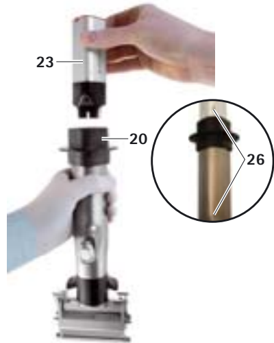
Fig. 4 Mise en place de l'entonnoir stérile dans le compartiment à accu
