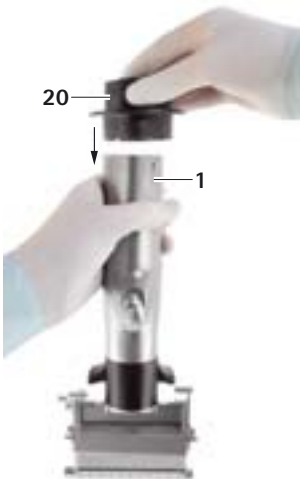
Fig. 3 Mise en place de l'entonnoir stérile
