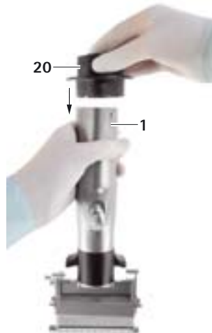
Rys. 3 Założyć lejek do sterylnego wkładania akumulatora
